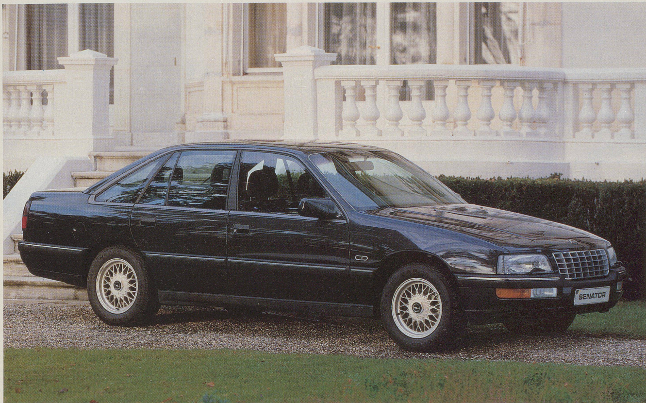
Senator CD: 3.0i-Sechszylinder, 130 kW (177 PS), elektronisch gesteuerter 4-Stufen-Automat, Servotronic-Lenkung, DSA-Fahrwerk mit Ride Control, ABS, Klima-Automatik.
