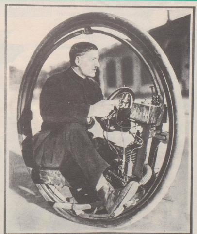
1923 erfand der italienische Ingenieur Cisloghi dieses einrädrige Motorrad. Sitz, Motor und Steuerung sind in einen festen inneren Stahlkreis eingebaut, während ein zweites, bewegliches und bereiftes Rad der Fortbewegung dient. Bei der Probefahrt erreichte Cisloghi eine Geschwindigkeit von 50 km/h. Über das Fahrgefühl liegen keine näheren
