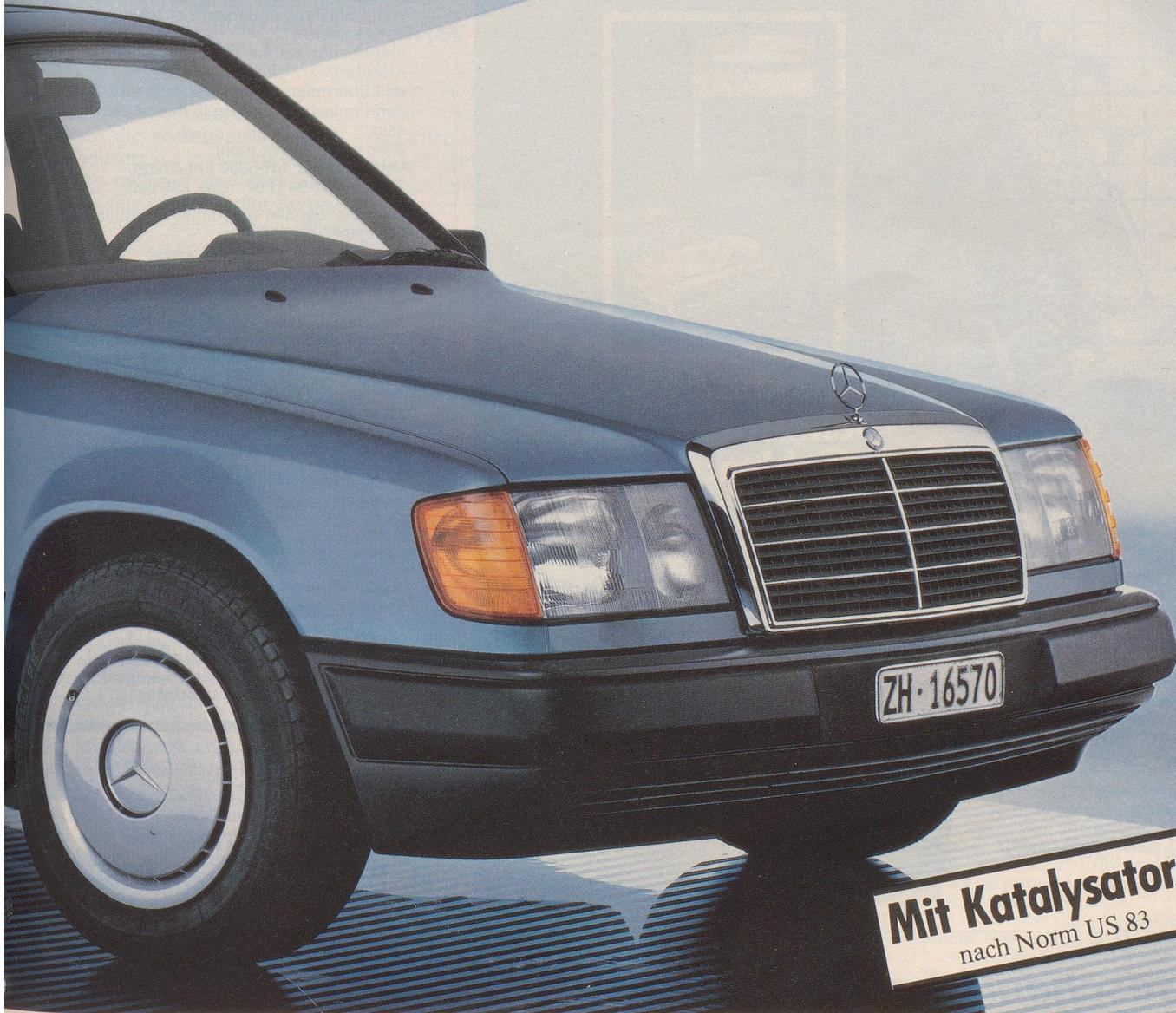
ständige Verbindung von Ästhetik und Funktionalität. Die abgeschrägte Frontpartie, fliessende Linien und das hochgezogene Wagenheck charakterisieren das aerodynamische Styling. Der beispielhafte Luftwiderstandsbeiwert ( $cW$ ) von nur 0,29 unterstützt die Forderung nach Umweltfreundlichkeit und Wirtschaftlichkeit.
