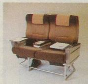
Das ist der neue, komfortablere und speziell für die Business Class entwickelte Sitz. Er ist in allen B-747 nur 8mal und in allen DC-10 nur 7mal pro Reihe installiert. Aber nicht nur der Sitz, sondern auch der Sitzabstand ist in diesen beiden Flugzeugtypen grösser geworden: 97 Zentimeter.
