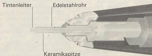
Die tuscheähnliche Farbe wird über ein ingenioses, federndes Faser-Tintenleitsystem durch ein Edelstahlröhrchen zur äußerst feinen, als Hohlkörper gefertigten Schreibspitze aus einem ganz neuartigen keramischen Material geführt. Dieses Material ist dauerhafter als Stahl, sodass sich die Spitze praktisch nicht abnutzt.
