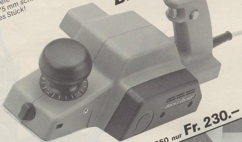
Serienmäßig: 2 Hartmetall-Wendemesser und Maulschlüssel. Einzigartig: Parkstellung «P» zum Messer versenken. Praktisch: Anschluss für Staubfangsack. Vorbildlich: 2 V-Nuten zum Kanten abschrägen bis 4,5 mm.
