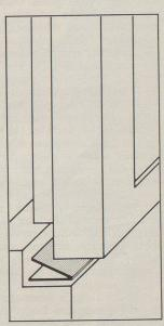
Scotch Weatherstrip: ein bewegliches «V», dessen Winkel sich als Windfänger der Breite von Fugen und Spalten massgerecht anpasst. Wo keine Zugluft durchkommt, weht auch kein Luftzug.
