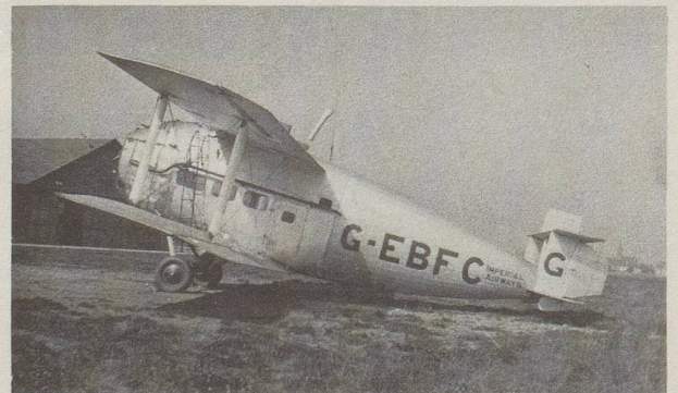
Die Flugsensation von 1924: Eine Vickersmaschine mit 500-PS-Napier-Lion-Motor kam regelmässig als Kursflugzeug über London und Paris nach Basel. Wir Schweizer nannten diese etwas mollige Flugdame respektlos «Die fliegende Sau».
