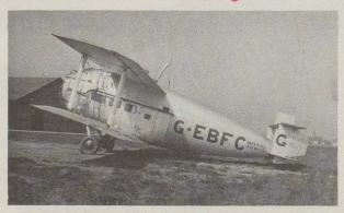
Die Flugsensation von 1924: Eine Vickersmaschine mit 500-PS-Napier-Lion-Motor kam regelmässig als Kursflugzeug über London und Paris nach Basel. Wir Schweizer nannten diese etwas mollige Flugdame respektlos «Die fliegende Sau».
