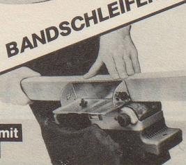
Stationär schleifen mit Queranschlag.
