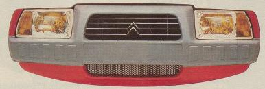
Zum Beispiel: die Stossstangen aus verformbarem Material, welche nach leichteren Stössen unbeschädigt wieder die ursprüngliche Form einnehmen.
