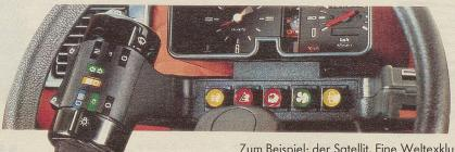
Zum Beispiel: der Satellit. Eine Weltexklusivität. Er vereint sämtliche Kontrollschalter unmittelbar beim Lenkrad. Er ermöglicht das Steuern, ohne die Hand vom Lenkrad und den Blick von der Strasse nehmen zu müssen.
