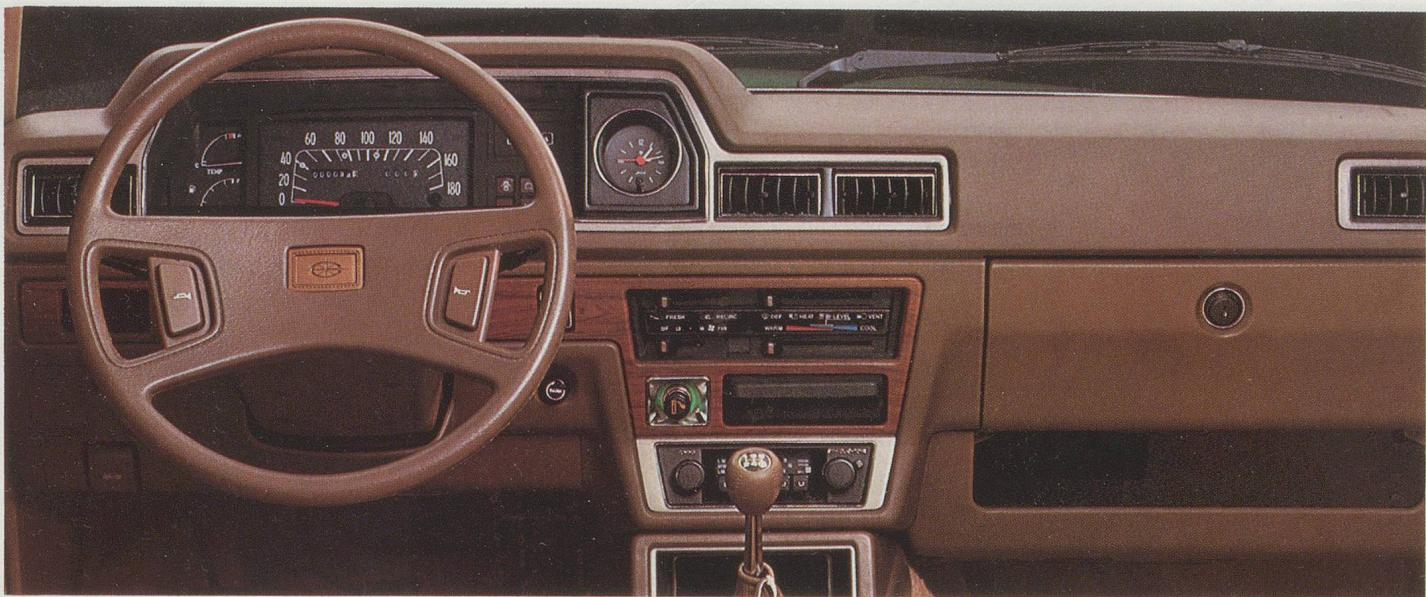
Das Design der Armaturen ist ebenso schön wie funktionell durchdacht. Alles ist leicht überschaubar und für den Fahrer in bequemer Reichweite. Kombischalter für Licht, Blinker, Scheibenwischer und Scheibendusche. Ölmanometer. Ampèremeter. Benzinwarnlicht. Fernthermometer. Tageskilometerzähler. Elektrische Quarzuhr.
