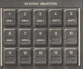
Ein Tuner mit Köpfchen In einem CMOS-Memory speichern Sie durch einfachen Tastendruck bis 15 Ihrer Lieblingssender. Stationsnummerund Frequenzanzeige durch Leuchtziffern.
