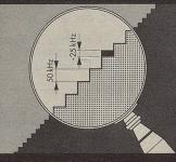
Rauschfrei von Station zu Station Eine Stummschaltung (Muting) unterdrückt das lästige Rauschen beim Abstimmen der Sender. Stationen unter einer einstellbaren Signalstärke werden übersprungen. Ein spezieller Schalter (High Blend) bringt selbst schwächere Stereosender rauschfrei herein.
