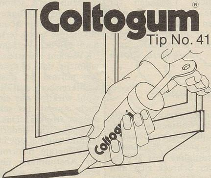
Der undichte Wetterschenkel an der Außenseite des Fensters lässt sich leicht selbst in Ordnung bringen, indem ein Strang Coltogum daruntergedrückt wird. Direkt aus der Tube oder aus der Kartusche. Das dauerelastische Coltogum in knallgelben Tuben und Kartuschen: ein hochwertiges Kleb- und Dichtmittel. In Eisenwaren-, Do-it-yourself-Geschäften und Drogerien.
