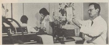
Mit Hilfe der Dünnschicht-Chromatographie werden Heilpflanzen-Extrakte analysiert.
