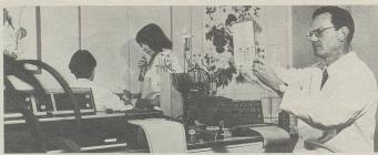
Mit Hilfe der Dünnschicht-Chromatographie werden Heilpflanzen-Extrakte analysiert.
