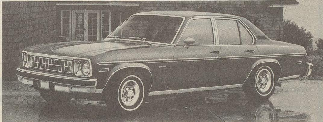
Chevrolet Concours Sedan (auch als Coupé erhältlich), V8-Motor, 3-Stufen-Automat, Servolenkung, Servobremsen, Einzelsitze mit Kopfstützen, verstellbares Lenkrad,
