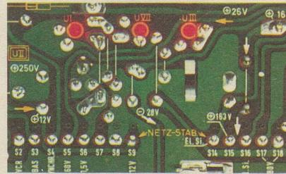
**vidom** das vollintegrierte Diagnosesystem mit opto-elektronischer Messanzeige. Chassis-integrierte Leuchtdioden für rationelle Fehlersuche im Service-Fall. Der gute Fachhandel informiert Sie gern und ausführlich.
