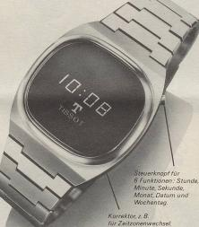
Quarz LED Digitalanzeige durch Leuchtdioden (lightemitting diodes). 100prozentig "solid state", also ohne bewegliche Teile. Ein kleiner Computer am Handgelenk. Programmiert für die Anzeige von Stunden, Minuten und Sekunden sowie von Monat, Datum und Wochentag. Die gewünschte Information erscheint nach Knopfdruck in helleuchtendem Rot auf dunklem Grund.
