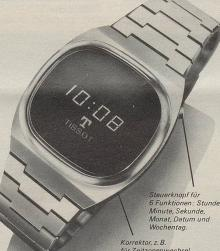
Quarz LED Digitalanzeige durch Leuchtdioden (lighteuchtdioden (lighteuchtdioden (lighteuchtdioden) also ohne bewegliche Teile. Ein kleiner Computer am Handgelenk. Programmiert für die Anzeige von Stunden, Minuten und Sekunden sowie von Monat, Datum und Wochentag. Die gewünschte Information erscheint nach Knopfdruck in helleuchtendem Rot auf dunklem Grund.
