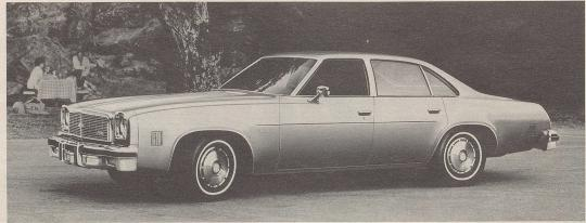
Chevrolet Chevelle Malibu Sedan (auch als Coupé erhältlich), V8-Motor, 3-Stufen-Automat, Servolenkung, Servobremsen, verstellbares Lenkrad, elektr. Scheibenbetätigung
