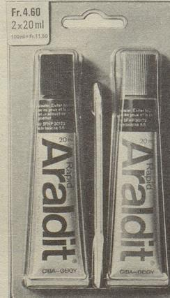
Araldit Rapid (rot) eignet sich speziell für kleinere Arbeiten. Denn die Mischung kann nur während 6–8 Minuten verarbeitet werden. Dann setzt die Härtung ein. 10 Minuten nach dem Zusammenfügen ist die Verbindung selbsttragend. Und nach 2–4 Stunden belastbar.
