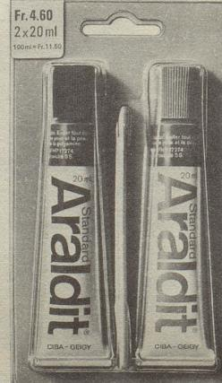
Araldit Standard (blau) eignet sich speziell für grössere Arbeiten. Denn die Mischung kann während 1–2 Stunden verarbeitet werden. Erst dann setzt die Härtung ein. In 6–8 Stunden ist die Verbindung selbsttragend. Und nach 24 Stunden belastbar.
