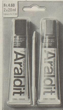
Araldit Standard (blau) eignet sich speziell für größere Arbeiten. Denn die Mischung kann während 1–2 Stunden verarbeitet werden. Erst dann setzt die Härtung ein. In 6–8 Stunden ist die Verbindung selbsttragend. Und nach 24 Stunden belastbar.
