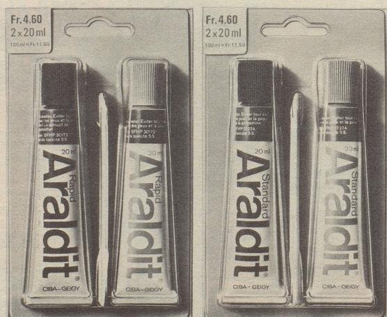
Araldit Rapid (rot) eignet sich speziell für kleinere Arbeiten. Denn die Mischung kann nur während 6–8 Minuten verarbeitet werden. Dann setzt die Härtung ein. 10 Minuten nach dem Zusammenfügen ist die Verbindung selbsttragend. Und nach 2–4 Stunden belastbar.
