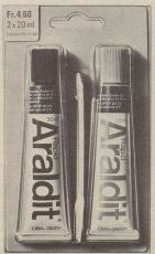
Araldit Rapid (rot) eignet sich speziell für kleinere Arbeiten. Denn die Mischung kann nur während 6–8 Minuten verarbeitet werden. Dann setzt die Härtung ein. 10 Minuten nach dem Zusammenfügen ist die Verbindung selbsttragend. Und nach 2–4 Stunden belastbar.
