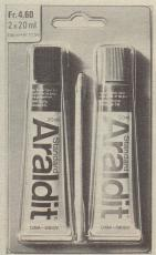
Araldit Standard (blau) eignet sich speziell für grössere Arbeiten. Denn die Mischung kann während 1–2 Stunden verarbeitet werden. Erst dann setzt die Härtung ein. In 6–8 Stunden ist die Verbindung selbsttragend. Und nach 24 Stunden belast-
