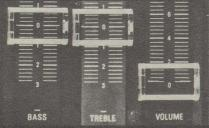
Mikrophon- und Linieneingänge bei der Aufnahme sowie Lautstärke, Höhen- und Bassregler bei der Wiedergabe werden durch Schiebepotentiometer bedient.
