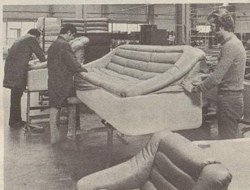
In der Polsterei werden Unter-, Seiten- und Rückenteile wattiert, bezogen, zusammengefügt, dekoriert und die Polstermöbel fertig ausgerüstet. Nach einer genauen Prüfung verlassen die fertigen Polsterguppen die Werkstätten.
