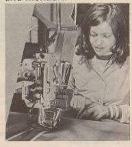
In der Näherei entstehen unterdessen die Kissenüberzüge. Leder und Stoff werden nach Schablonen angezeichnet, zugeschnitten, zusammengenäht, gefüllt und mit Polsterknöpfen garniert.
