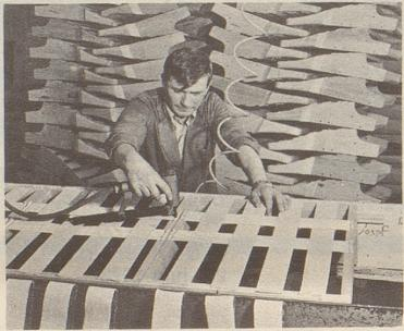
vom Rohlager gelangen Polsterwatten, Schaumstoffe, Holzgestelle und weitere Einzelteile in die Fabrikation. Hier wird zugeschnitten, geleimt, begurtet, geschliffen, lackiert, bezogen und montiert.
