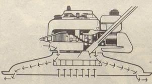
Der Motor treibt ein Turbinenrad. Das Turbinenrad saugt Luft unter das Mäher-Gehäuse. Im Gehäuse formt die Luft sich zum Kissen. Das Luftkissen gleicht das Mähergewicht aus: Und der Rasenmäher schwebt!
