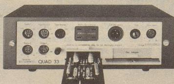
Die Empfindlichkeit der QUAD-Vorverstärker ist mit 0,5 mV ausserordentlich hoch. Dank erstklassigen Klangreglern und Filtern vermag der QUAD 33 Vorverstärker auch mittelmässige Programmquellen optimal wiederzugeben.
