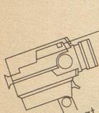
Sankyo bringt die erste Filmkamera der Welt mit dem neuen Hi-Focus System für problemlose, zentimetergenaue Scharfeinstellung. Es arbeitet allerdings nicht mit Laser-sondern mit optischen Strahlen, welche durch zwei Hilfsobjektive aufgenommen werden. Die Bedienung ist kinderleicht: Nur noch zwei verschiedene aufgenommenen durch Drehen der Sonnenblende zur Deckung bringen und die Distanz ist 100% genau eingestellt, ganz unabhängig von der Zoomeinstellung.
