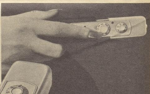
Die Minox C hat einen kleinen Computer mit Transistoren, Dioden, Kondensatoren, Elektromagneten. Ein ganzes Arsenal ausgeklügelter Technik. Schneller als Sie einen Gedanken fassen können, ermitteln CdS-Fotowiderstand und ein Minicomputer die genaue Belichtungszeit. Exakter als man sich vorstellen kann, arbeitet der elektronische Verschluss. Bis zur 1/1000 Sekunde.
