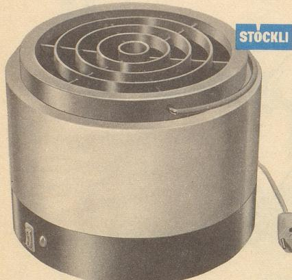
Casana Vapor ist ein preiswerter Luftbefeuchter, der seinen Preis wert ist: 6-Liter-Wasserbehälter aus rostfreiem Chromnickelstahl 18/8, Stundenleistung bis 4 dl (geräuschlose Verdampfung), schlag- und kratzfestes Kunststoffgehäuse (weiss/hellgrau), Ringheizung, Thermo- stat, Zweistufenschalter, Kontroll-Lampe.
