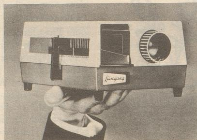
Neuester, äußerst günstiger Dia-projektor für Format 5 x 5 cm, halbautomatisch, mit tadelloser Ausleuchtung des Bildes durch Jodquarz-Lampe 12 V / 50 W, unter Verwendung des universellen LIESEGANG-Dia-magazins. Objektiv 1:2,8 / 85 mm.
