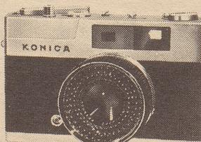
Fehlbelichtungen sind unmöglich. Der Auslöseknopf wird gesperrt, wenn die Lichtverhältnisse nicht in Ordnung sind. Normalformat 24x36mm Blitzlichtautomatik, lichtstarkes, 5-linsiges Objektiv F/2.8/40mm, gekuppelter Telemeter, Leuchtrahmensucher mit Parallaxenausgleich. Kompakt, handlich, leicht.
