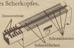
Jeder der 3 Doppelscherköpfe enthält 2 Innenmesser, 2 Schneidmesser, 4 Schneidkanten. Lange Haare werden direkt an den Kanten geschnitten, kurze oben auf den Schneidflächen.
