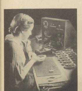
Den mit der Fabrikation beschäftigten Uhren-Arbeitern und -Arbeiterinnen liegt die Subtilität im Blut. Zur Bedienung des Prüfstandes für die Einregulierung des Motors, den die nebenstehende Aufnahme zeigt, eignen sich in hervorragendem Maße Frauen. Sie haben Fingerspitzengefühl und sorgen mit peinlicher Genauigkeit für schwankungslosen Lauf des Motors.
