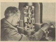
Maschine zum Nieten der Rotorbleche
