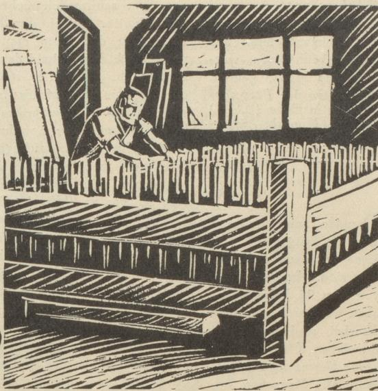
Fourniere sind ganz feine Holzblätter, die kreuz und quer mit einer Belastung bis zu 300 Zentner auf das Blindholz geleimt und aufgepresst werden. Dadurch wird große Widerstandsfähigkeit des fertigen Möbels erzielt.
