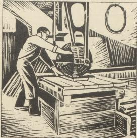
Der erste Mann, der nach der Lagerpflege das Holz zur weiteren Verarbeitung in die Hände bekommt. ist der Zuschneider. Nach Plänen teilt er die Stücke ein, um möglichst wenig Abfall zu haben. Das brauchbare Holz wird dann mit der Hobelmaschine zugerichtet.
