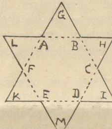
Der Grundriss des Pavillons, der ein regelrechtes Sechseck darstellte, wurde so vergrössert wie Zeichnung es oben zeigt. A B C D E F ist der Grundriss des alten, A G B H C I D M E K F L der des neuen Pavillons. Die Aufgabe war dadurch erleichtert, dass das Dach des Pavillons bereits auf die Lösung hinwies; klappt man nämlich die sechs (dreieckigen) Dachteile auseinander, so ergeben sie ein gleichseitiges Zwölfeck doppelter Grundfläche.
