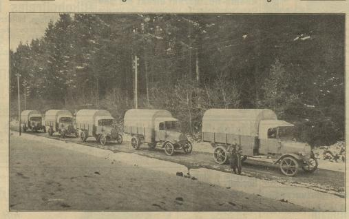
Lastzüge bis 10 Tonnen Tragkraft
