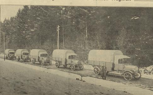
Lastzüge bis 10 Tonnen Tragkraft
