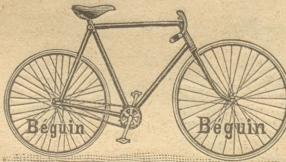
Ouragan mit Holzfelgen, stärker und leichter als jede Stahlfelge, Strassen-Maschine, 12 Kg., komplet, ganz aus Gussstahl gearbeitet, mit härtem Rohr. — Leichtester Gang. — Béguin-Fahrräder von bestem Stahl verfertigt von Fr. 300 an.
