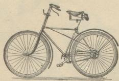
Bicyclettes, Rahmenbau, Kugelsteuerung, Kissenreifen, complet von Fr. 250.—, mit Pneumatics von Fr. 350.— an bei 87,6
