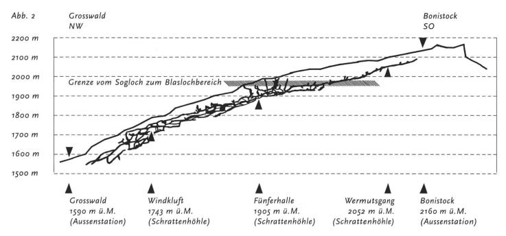
Schematische Darstellung (1:10000) der Geländeoberfläche und der Schrattenhöhle mit: 2 Aussenstationen auf 1590 m ü.M.; 3 Messstationen in der Höhle mit je 150 m Höhendifferenz.
