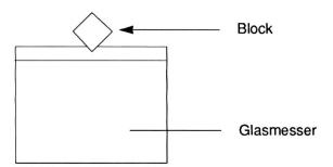
**Figur 2:** Orientierung des Blockes zur Verhinderung eines Staues mit anschliessender Verformung im oberen Teil des Blockes. Durch die Anordnung in einem Winkel von etwa 45° zur Messerkante können auch grössere Blöcke in weicherem Plastik geschnitten werden.
