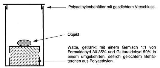
Figur 1: Anordnung zur Fixierung in Aldehyd-Gas.
