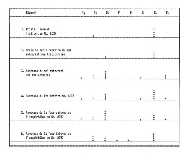
La figure 2 compare 6 spectres représentés schématiquement. La notation semi-quantitative est la suivante: "+" correspond à un petit pic nettement discernable du "fond", "+++++" correspond à un grand pic nettement au dessus des autres, "++", "+++" et "++++" sont les valeurs intermédiaires. Dans le cas de la fig. 1, on aurait donné respectivement + et +++++ pour les pics du <u>Silicium</u> et du Calcium.
