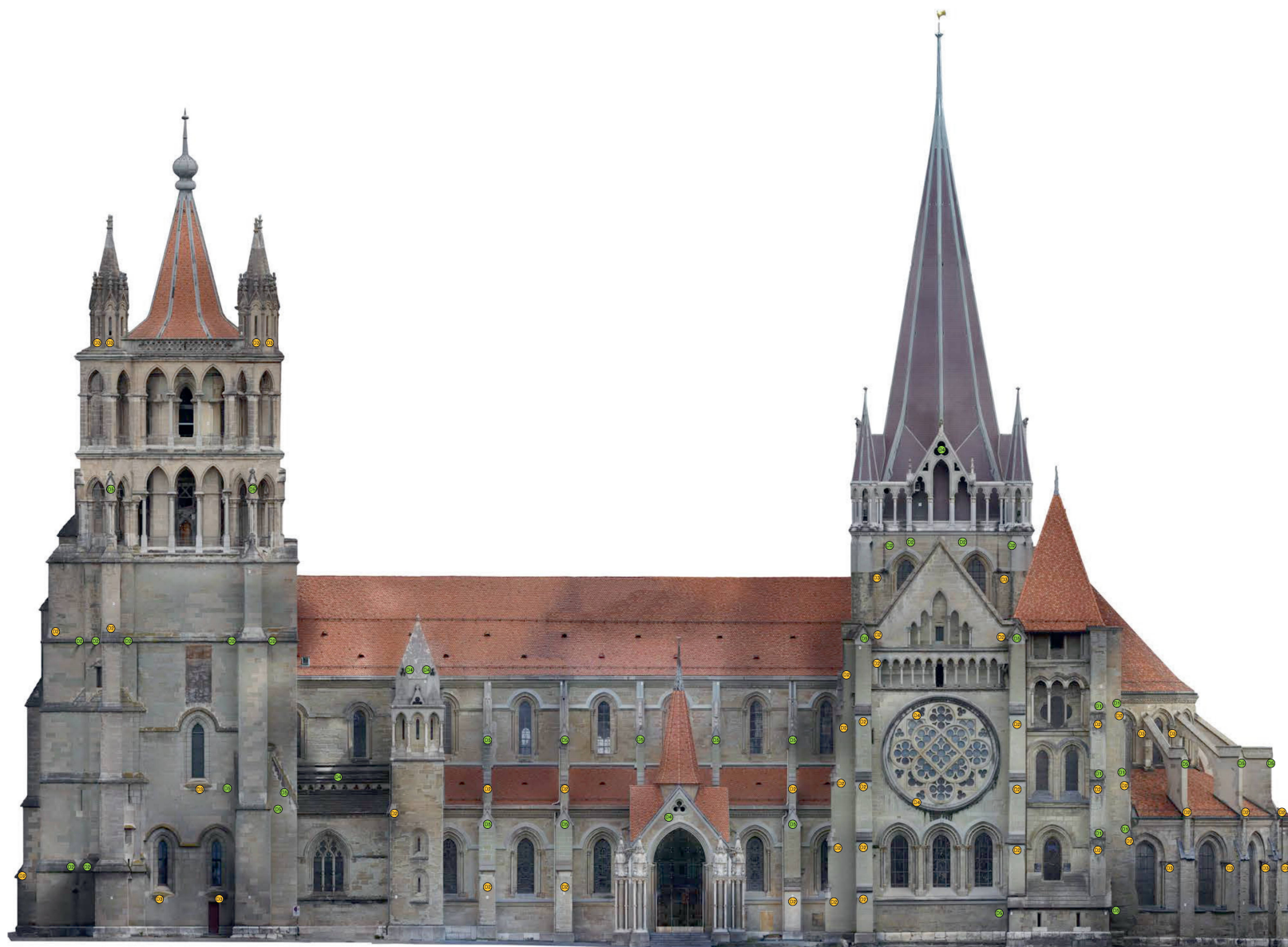
C6 Élévation sud avec inventaire des interventions proposées pour la résolution des dysfonctionnements. Ces interventions sont ici répertoriées en deux catégories: les solutions par la pierre et celles par la ferblanterie (Amsler Dom arch. sur base Archéotech, 2020).
