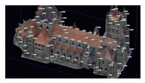
**6** Le modèle 3D obtenu par photogrammétrie montrant la position de toutes les cibles utilisées pour l'orientation et la calibration métrique du modèle dans le système de coordonnées de la cathédrale.
