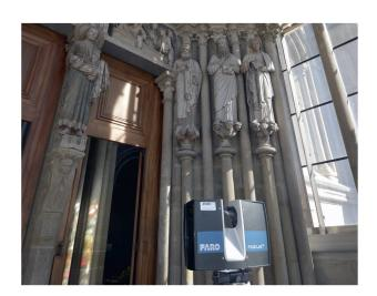
**2** Le scanner Faro \$350 lors de la mesure du Portail peint; l'instrument tourne à 180 degrés sur le plan horizontal et le miroir tournant projette le rayon laser sur le plan vertical à raison de 980 000 mesures par seconde.
