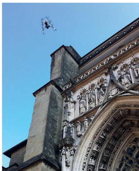
7 Le drone Asctec Falcon durant les prises de vue photogrammétriques du portail occidental. L'avantage du drone est la possibilité d'accéder de face à toutes les parties inaccessibles du sol.
