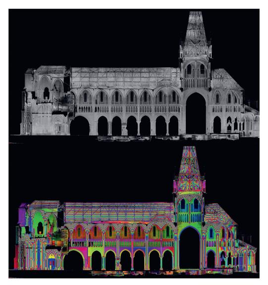
4 Le nuage de points peut être coupé et projeté selon n'importe quel plan de l'espace; ici, la coupe longitudinale de la cathédrale avec, en haut, l'image en intensité de lumière laser et, en bas, l'image colorisée par profondeur des pixels par rapport au plan de coupe par bandes d'un mètre.
