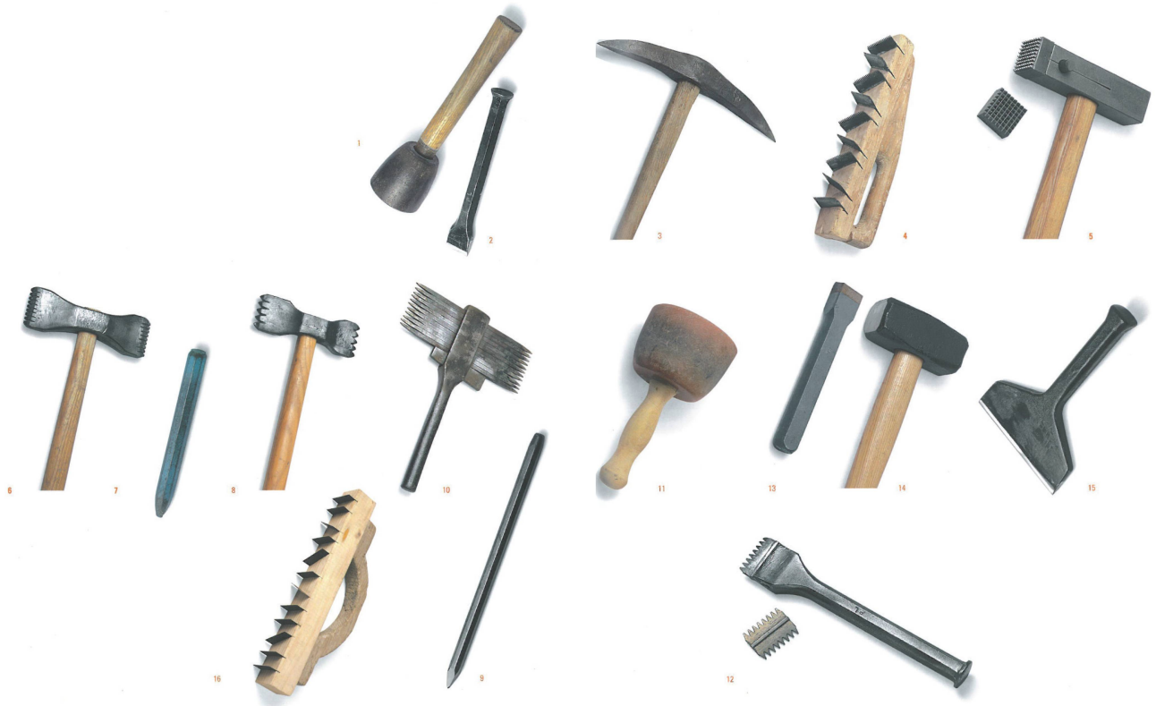
1 Les outils du tailleur de pierre (tiré de la Charte d'éthique et de bienfaisance pour la réfection de monuments et de bâtiments de l'Association romande des métiers de la pierre). Outillage à percussion lancée: pique (3); boucharde et plaquette (5); taillant bretté (6); taillant grain-d'orge (8); peigne (10). Outillage à percussion posée avec percuteur: ciseau (2); broche vidia (7); broche à pierre dure (9); gradine et plaquette (12); chasse (13); réparoir (15). Percuteurs: massette portugaise (1); maillet (11); massette (acier) (14). Outillage à percussion posée sans percuteur: rabot à dents (calcaire tendre) (4); rabot à molasse (16).
