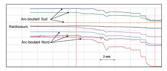
5 Évolution des contraintes dans les arcs-boutants de l'axe 8 mesurée par les capteurs «Treyvaud» lors de la mise en tension (de 0 à 50kN) des tirants provisoires. Les arcs de chaque côté sont soulagés, mais pas symétriquement; les raidisseurs ne réagissent pratiquement pas.
